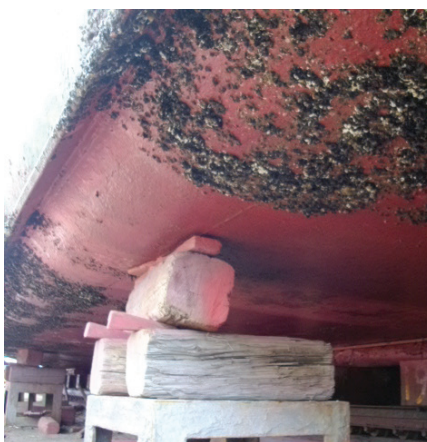
Bilderna visar hård påväxt på fartygsskrov. Den icke bevuxna sektionen på bilden i mitten har målats med Selektope-baserad färg.
